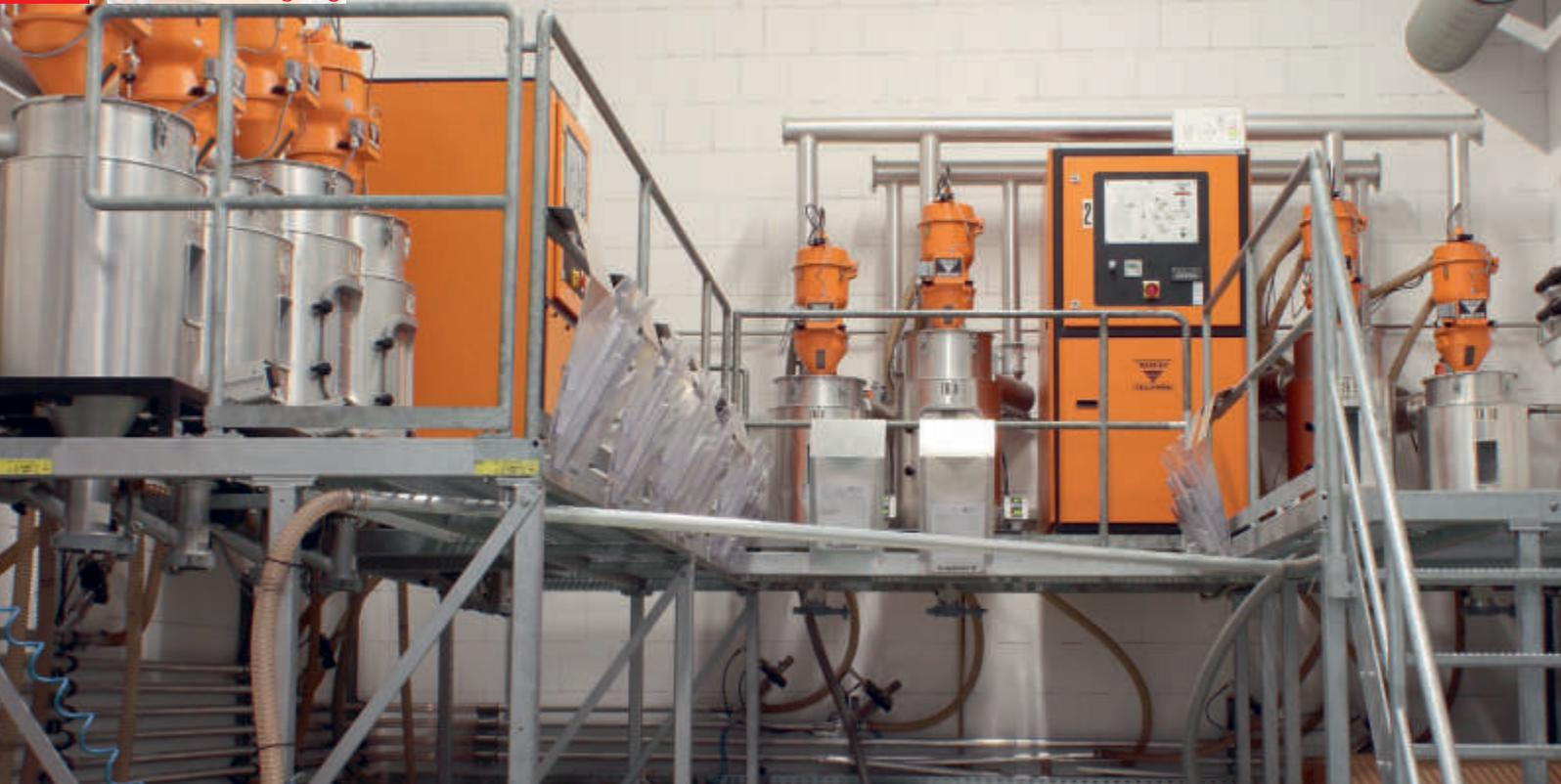
Die Trocknungsanlage in Werk 2 befindet sich auf einer speziell angefertigten Bühne in drei Meter Höhe über dem Materiallager. Die Anlagensteuerung sorgt dabei für höchstmögliche Energieeinsparung gepaart mit einem Schutz vor Über-trocknung des thermisch empfindlichen Materials.
