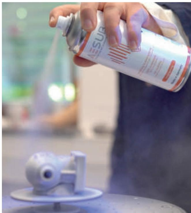
Ein Ventil wird dem Scanningspray besprüht und kann so vom 3D-Scanner besser erfasst werden (Bild: Aesub).
