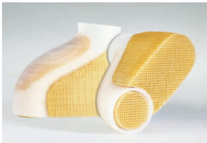
Mit Stützmaterialien in Gitterstruktur lassen sich komplexe Geometrien in kurzer Bauzeit realisieren (Bild: Arburg).
