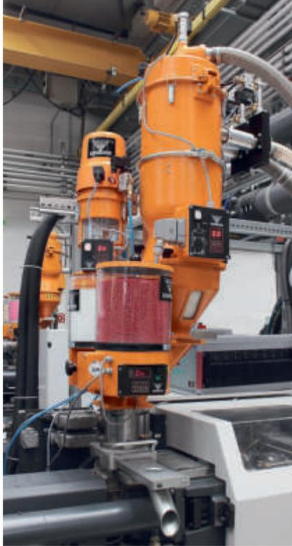
Beim Einfärbegerät »KEM« wird die Hauptkomponente über einen freien Zulauf beigegeben. Zwei Stationen werden verwendet, wenn zusätzlich zur Einfärbung mit Masterbatch auch noch Additive zudosiert werden. Hier wird als Hauptkomponente neben Neuware noch prozentanteilig Mahlgut beigegeben.
