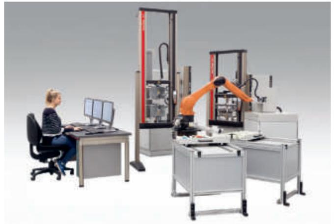
Das Roboter-Prüfsystem liefert reproduzierbare Ergebnisse der Zug- und Biegetests von Kunststoffteilen (Bild: ZwickRoell).
