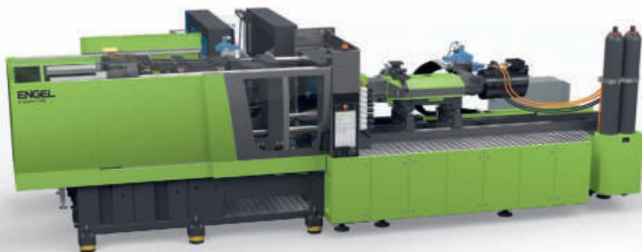
Dank neuer Hochleistungsspritzereinheit lassen sich Dünnwandbehälter aus PET und rPET produzieren (Bild: Engel).
