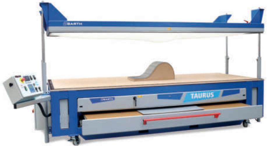
Mit den Vakuumpressen erfolgt das Durchwärmen der Mineralwerkstoffplatten schonend und gleichmäßig (Bild: Barth).
