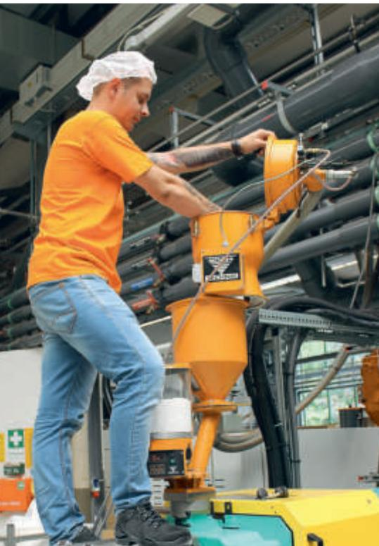
Die Geräte sind modular aufgebaut und können in einem Baukastensystem zusammengestellt werden. Die Förderhauben lassen sich klappen und der Förderkörper seitlich wegschwenken – direkt auf der Maschine und völlig ohne Werkzeug.
