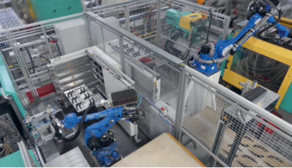
Dank 6-Achs-Roboter können 2K-Bauteile auf zwei 1K-Spritzgießmaschinen effizient gefertigt werden.
