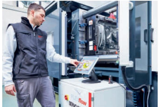
Die Mensch-Maschine-Schnittstelle wurde grundlegend überarbeitet (Bild: Oerlikon HRSflow).
