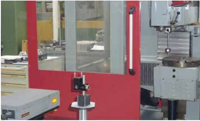
Werkzeugmaschinenanalyse mit Laserinterferometer: Aus der Analyse der Daten lassen sich Modelle erstellen, mit denen die Werkzeugmaschine optimiert werden kann.
