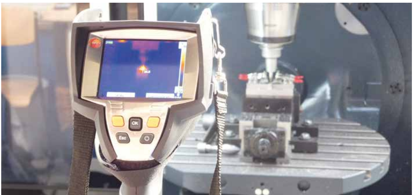
Thermische Prozessanalyse: Mit den Daten kann der Prozess des Fräsens besser verstanden werden.
