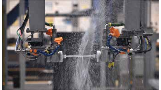
Bei der Ultraschallprüfung von Fill müssen über den Wasserstrahl gekoppelte Signale mit geringer Abweichung ankommen (Bild: P. Kempfner/Fill).
